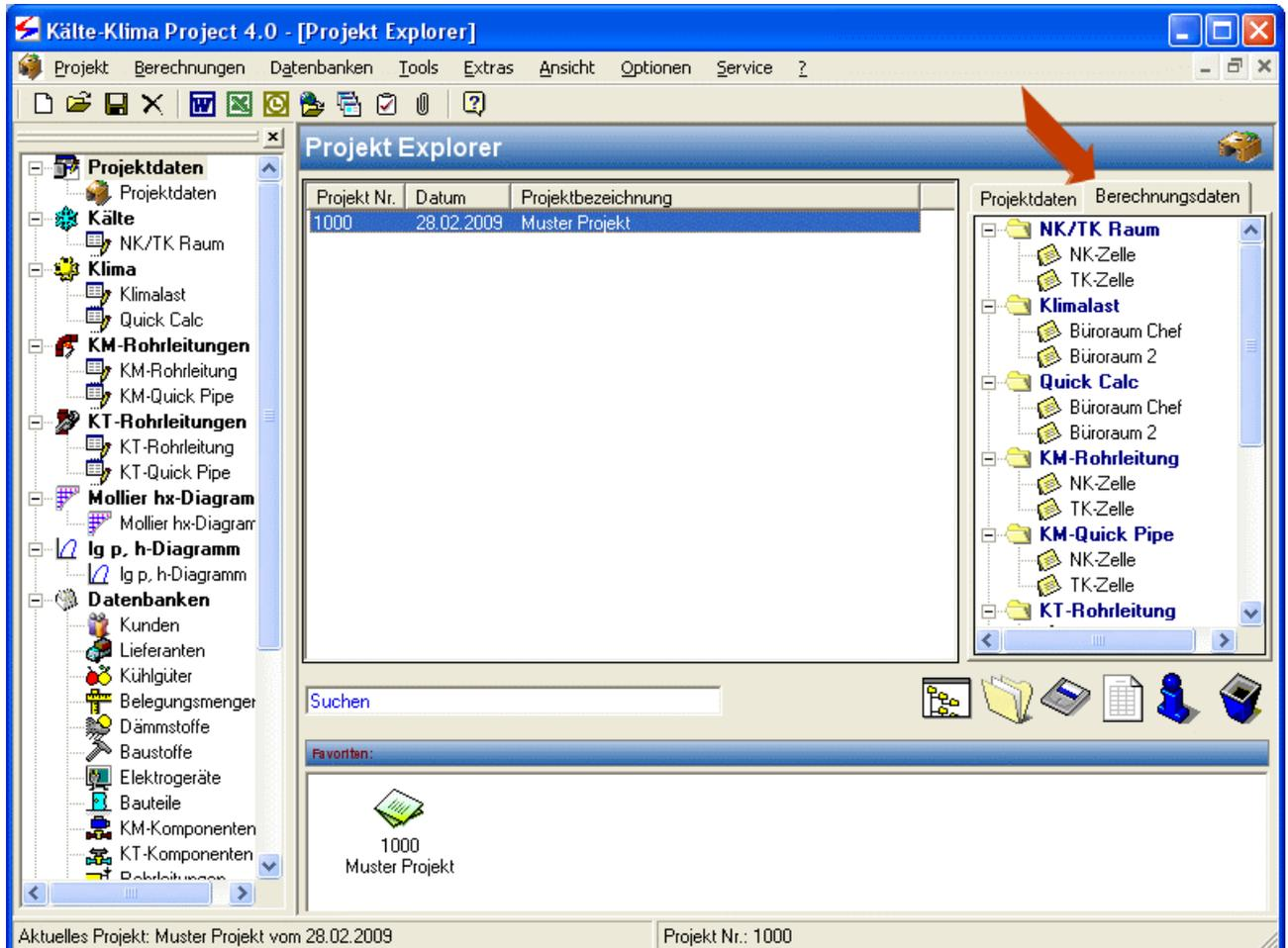
Beim Laden eines Projektes wird diese Tab-Karte mit den vorhandenen Berechnungen gefüllt. Sie haben dadurch sofort eine Komplett Übersicht Ihrer Berechnungen, weiterhin gelangen Sie beim anklicken der Berechnung sofort zur Bearbeitung.
