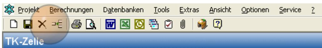
Durch die Neuen Buttons Einfügen und Löschen, können Sie jetzt eine neue Berechnung den vorhanden zwischenfügen. Gleichzeitig wird beim Löschen die Reihenfolge neu sortiert so dass keine leeren Berechnungen mehr dazwischen stehen bleiben.
